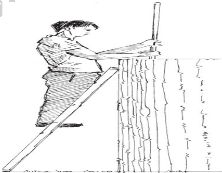
نمودار ۱۱: شستشوی مخازن آب با استفاده از برس دسته بلند
